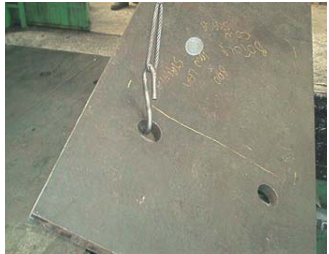
In questa fotografia viene mostrata, oltre al gancio autocostruito non idoneo, un'imbracatura effettuata in modo pericolosamente approssimativo!
